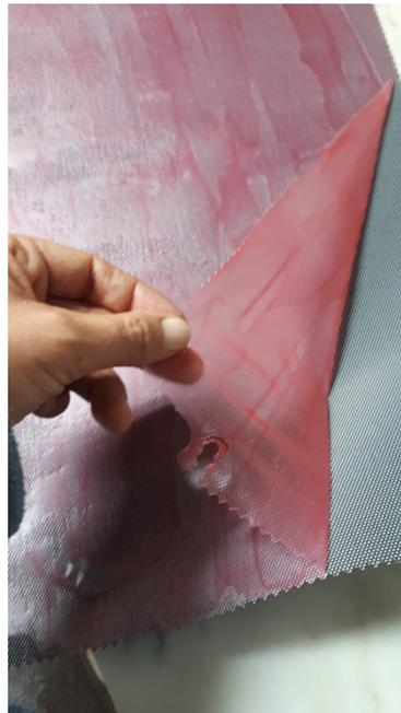
Figura 1. Filme de bioplástico à base de amido de milho com corante alimentar vermelho.
